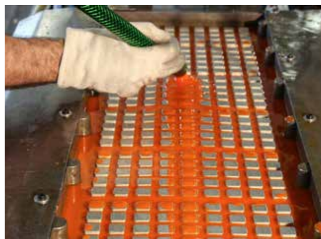
Produzione - colata di un vaglio di plastica
