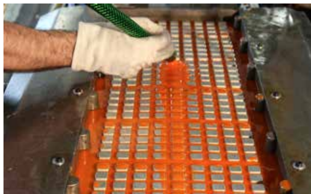
Production – Moulage d'un panneau en polyuréthane
